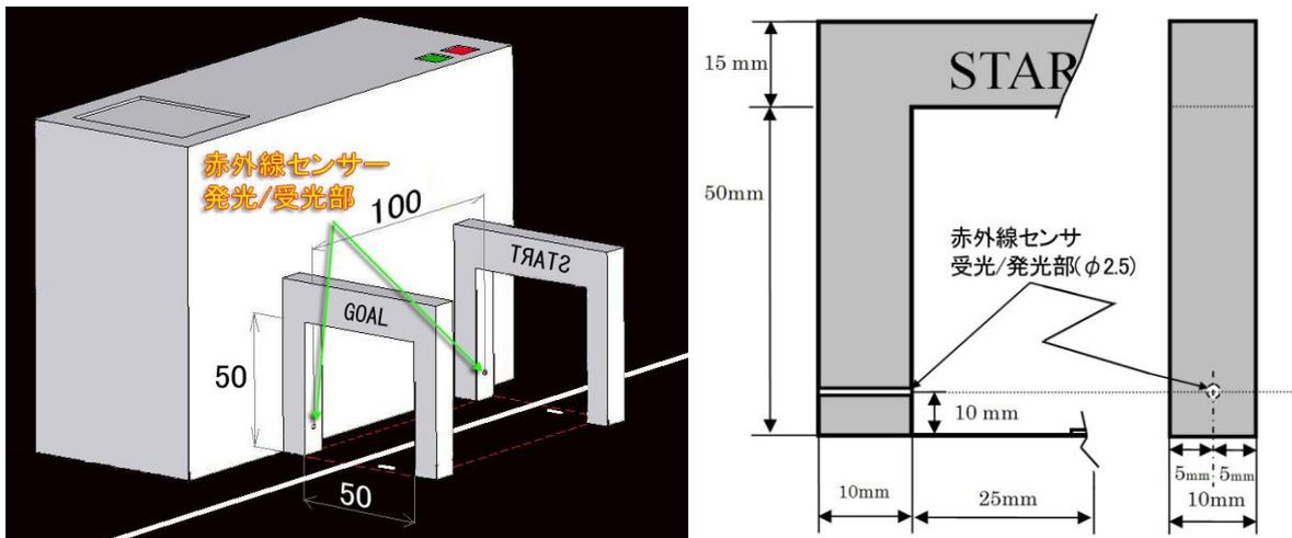
図7 自動計時装置（高さ10mmの赤外線を遮断して「通過」を判定）
